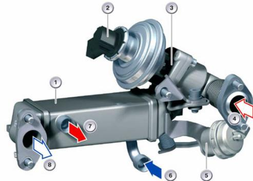
La réintroduction d'une partie des gaz d'échappement à l'admission réduit la masse d'air admise et, par là, la quantité d'oxygène et d'azote disponibles pour la combustion. La température de combustion et la formation d'oxydes d'azote sont diminuées, surtout lorsque les gaz recirculés sont refroidis dans un échangeur de chaleur.
