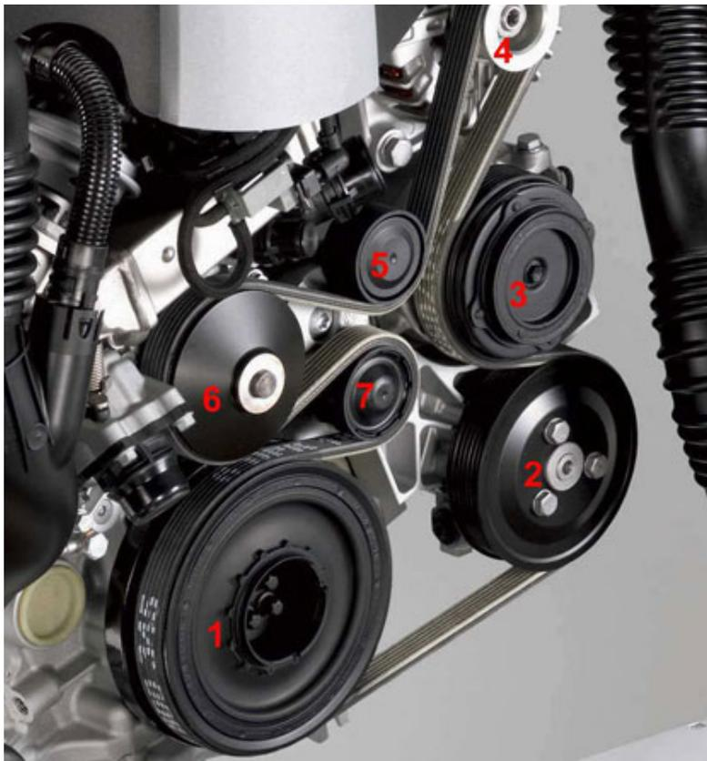
1. Amortisseur de vibrations de torsion (damper) de nez de vilebrequin – sur roue libre avec BVM
