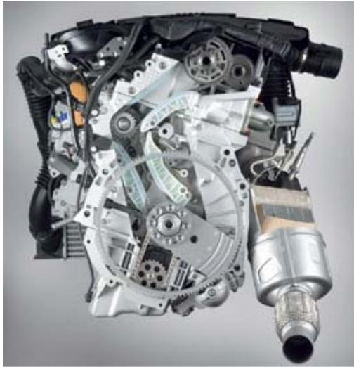
Les durées d'ouverture indiquées sont de 221,8° à l'échappement et de 216° à l'admission, avec des centres de lobes calés à 108° avant le PMH pour l'échappement et 100° après le PMH pour l'admission. Il en résulte un diagramme de distribution de 39,3° - 2,5° - 8° - 28°.
