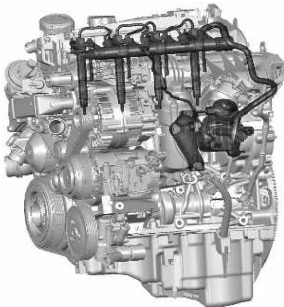
Le moteur est proposé en trois variantes de puissance qui se différencient par leur équipement d'injection Bosch à rampe commune et leur système de turbosuralimentation. Alors que la version de 105 kW a des injecteurs électromagnétiques alimentés sous une pression de 1 600 bars, les deux moteurs plus puissants disposent d'injecteurs piézo-électriques capables de 5 injections par cycle ; leur pression d'injection est portée respectivement à 1 800 et 2 000 bars.
