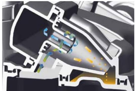
Les séparateurs cycloniques sont particulièrement efficaces et ils amortissent aussi les pulsations de gaz, ce qui évite d'exciter la membrane du régulateur de pression. Les gaz de fuite épurés passent ensuite dans ce régulateur avant d'être aspirés dans le tuyau d'air d'admission allant du filtre à air au turbocompresseur.
