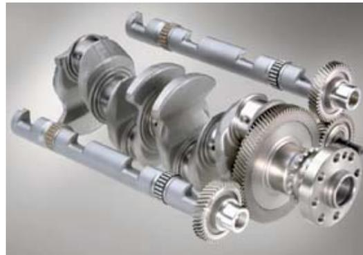
Les roulements à aiguilles ne sont pas alimentés séparément en huile. Pour que les arbres d'équilibrage tournent deux fois plus vite que le vilebrequin, leurs pignons d'entraînement ont 44 dents alors que la couronne dentée sur le vilebrequin à 88 dents.
